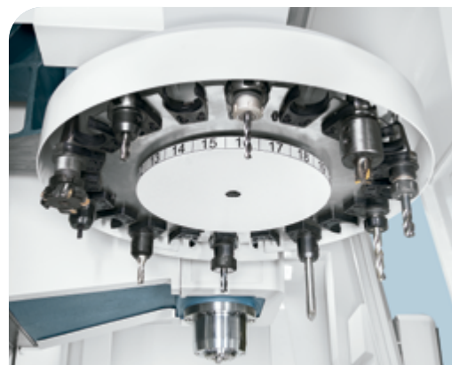
Cambio-utensili automatico con capacità di 20 utensili (ROMI D 600)
