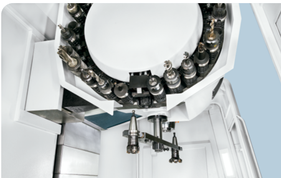
Cambio-utensili automatico con capacità di 30 utensili (ROMI D 800/ D1000/ D1250)
